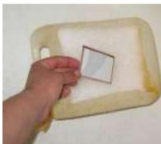
Рисунок 7. Накладывание на хлорногидратный текстолит железа
